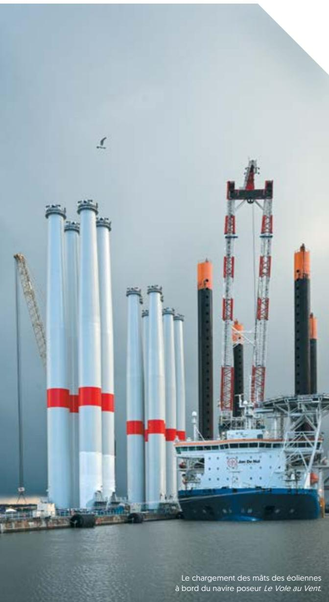
Le chargement des mâts des éoliennes à bord du navire poseur *Le Vole au Vent*.
