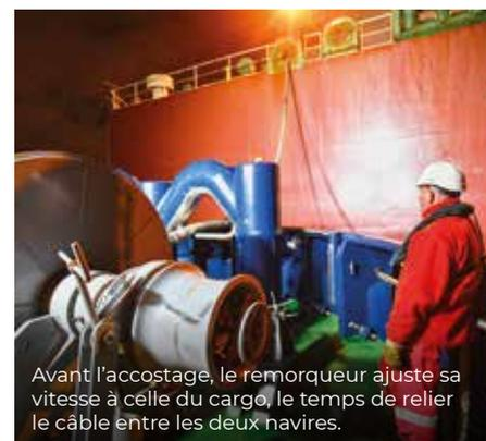
Avant l'accostage, le remorqueur ajuste sa vitesse à celle du cargo, le temps de relier le câble entre les deux navires.
