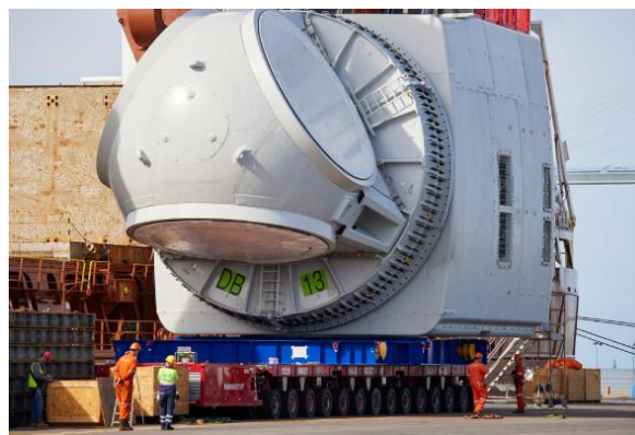
Export des nacelles Haliade produites par General Electric, depuis le quai dédié de Montoir de Bretagne.
