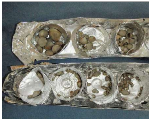
Figure 10 : Mesure de la biomasse des organismes benthiques. Séchage en étuve à 55°C (48 h minimum) puis pesée avant ignition à 450 °C pendant 4 heures.
