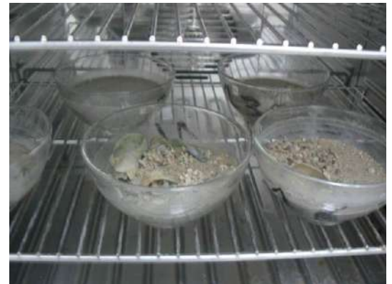
Figure 13 : Echantillons granulométriques à l'étuve (Cliché TBM)
