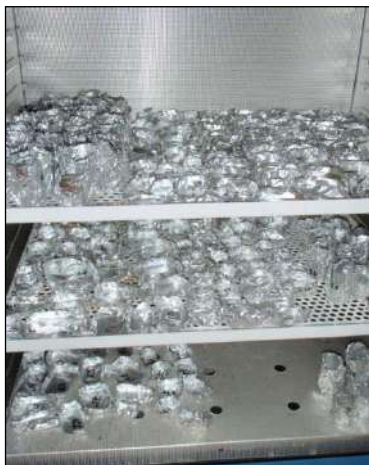
Figure 10 : Mesure de la biomasse des organismes benthiques. Séchage en étuve à 55°C (48 h minimum) puis pesée avant ignition à 450 °C pendant 4 heures.
