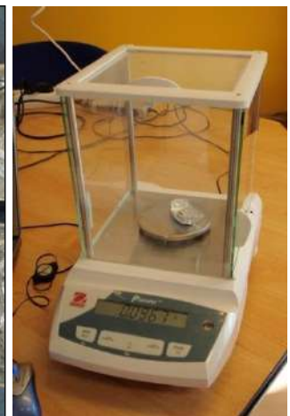
Figure 10 : Mesure de la biomasse des organismes benthiques. Séchage en étuve à 55°C (48 h minimum) puis pesée avant ignition à 450 °C pendant 4 heures.
