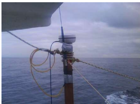
Figure 2: Antenne GPS et récepteur radio positionnés à l'aplomb du sondeur.
